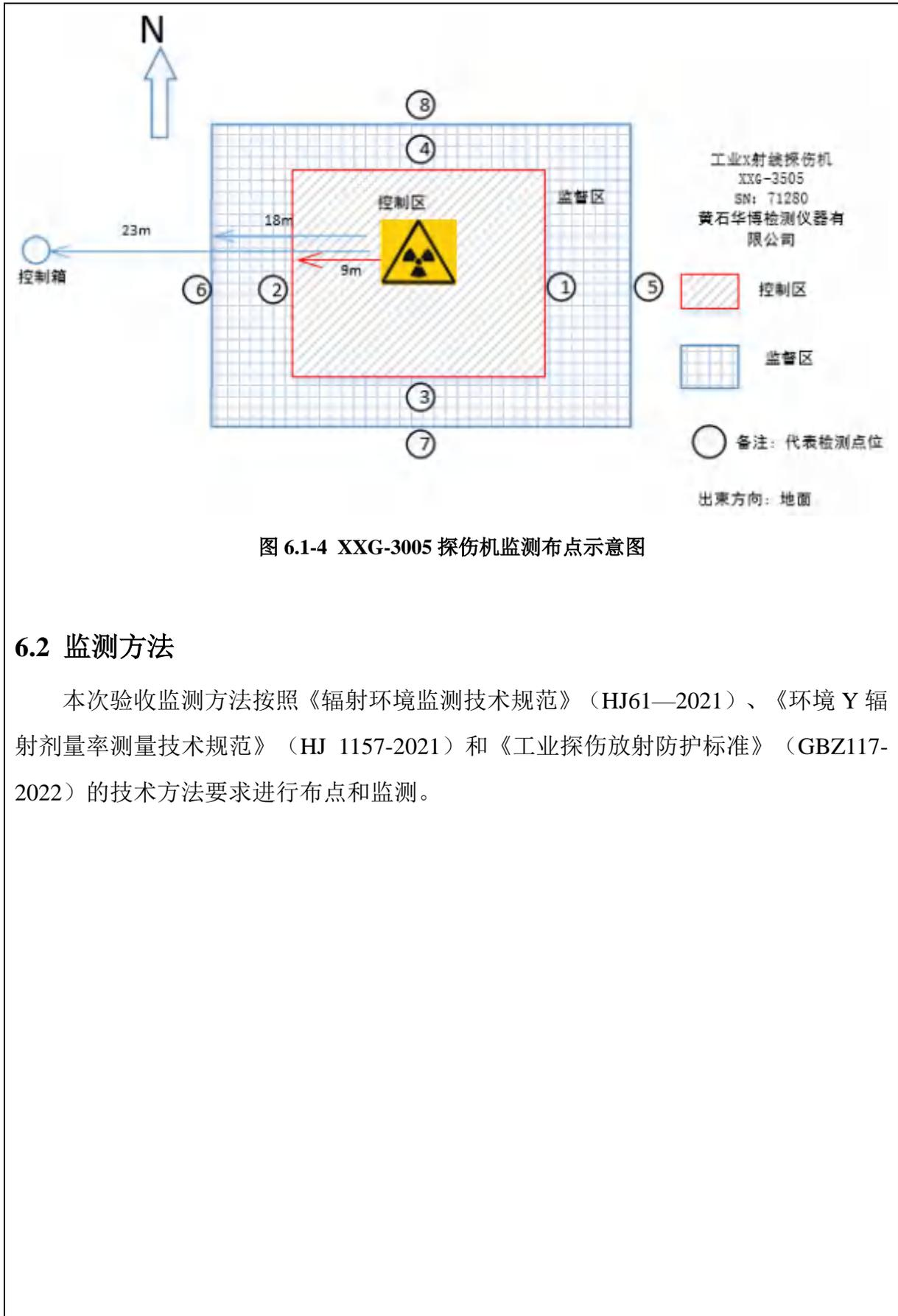
图 6.1-4 XXG-3005 探伤机监测布点示意图
